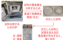
人体に有害な重金属を測定するために試料を灰化する様子
